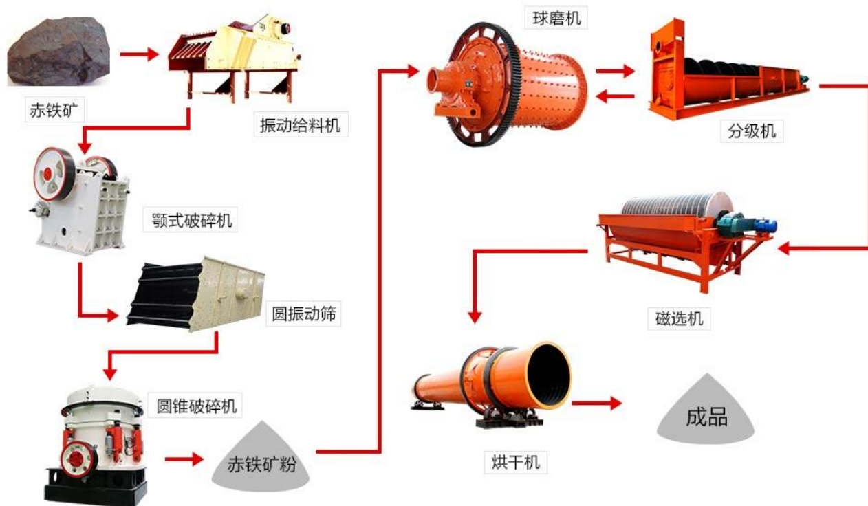
图：矿石分选及所需设备流程（以赤铁矿为例）
